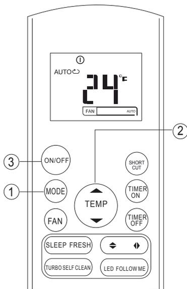
При работе в режиме AUTO кондиционер автоматически выбирает настройки и режим работы в зависимости от необходимой температуры, выставленной на пульте управления, и температуры в помещении.
