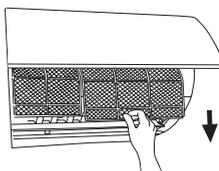
2. Очистите поверхность фильтров. Используйте пылесос или положите фильтр под струю холодной воды. Не пользуйтесь моющими средствами для мойки фильтров, пользуйтесь только холодной водой. Не устанавливайте фильтр на место до тех пор, пока он не высохнет.
