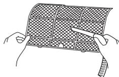
3. Установите фильтры на место. Аккуратно вставьте фильтр в пазы, и двигайте его вверх. Пожалуйста, не применяйте излишнюю физическую силу при установке, вы можете порвать фильтр.
