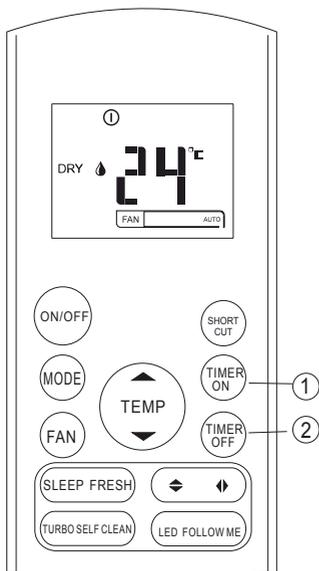
Нажмите кнопку **TIMER ON**. Отобразятся текущие настройки таймера и будет мигать индикатор. Снова, с перерывом не более 5 секунд, нажмите **TIMER ON** для изменения времени. Время изменится на 0,5 часа. Если держать клавишу непрерывно, время будет изменяться быстрее. Установите время включения кондиционера.
